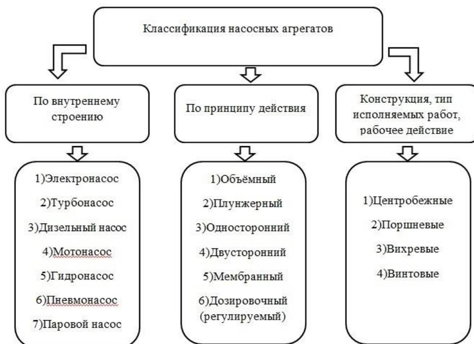
Рисунок 1 Классификация насосных агрегатов
