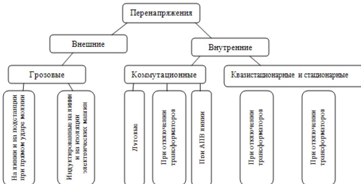
Рисунок 1 – Основные виды перенапряжений в электроэнергетических сетях
