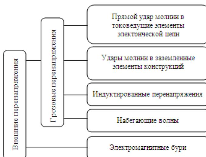
Рисунок 2 – Классификация внешних напряжений
